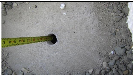
Zaměření tloušťky betonové mazaniny, 40 mm
