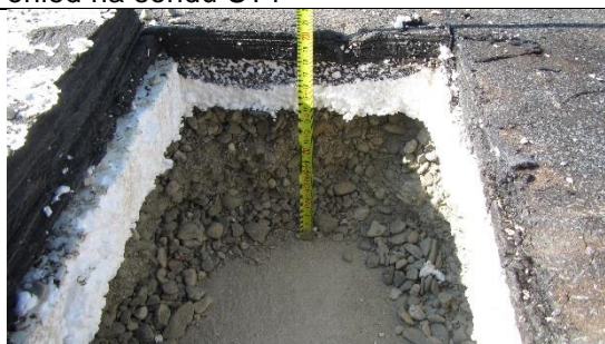
Zaměření celkové výšky, 200 mm
