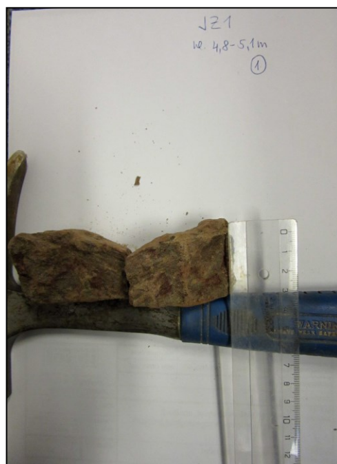
Obrázek 3: Stanovení pevnosti na horninovém vzorku JZ1 (hloubka odběru 4,8 – 5,1 m). Pevnost horniny R5 (2,2 MPa).
