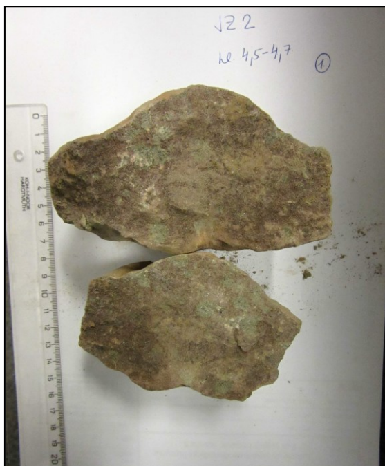
Obrázek 2: Stanovení pevnosti na horninovém vzorku JZ2 (hloubka odběru 4,5 - 4,7 m). Pevnost horniny R3 (22,5 MPa).
