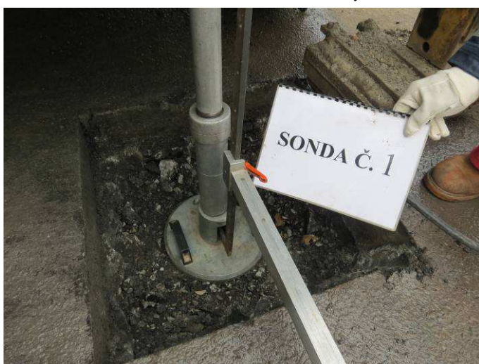
Obr. 3.G Sonda č.1 – měření konstrukční vrstvy
