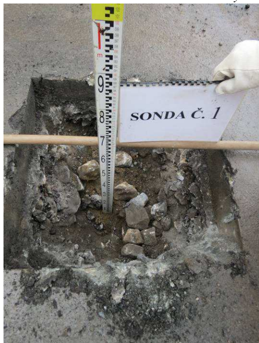
Obr. 3.G Sonda č.1 – měření konstrukční vrstvy
