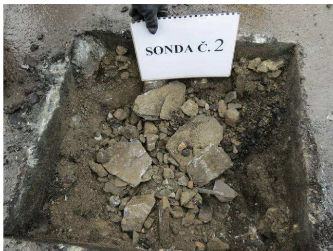
Obr.6.G Sonda č.2 - materiál konstrukční vrstvy
