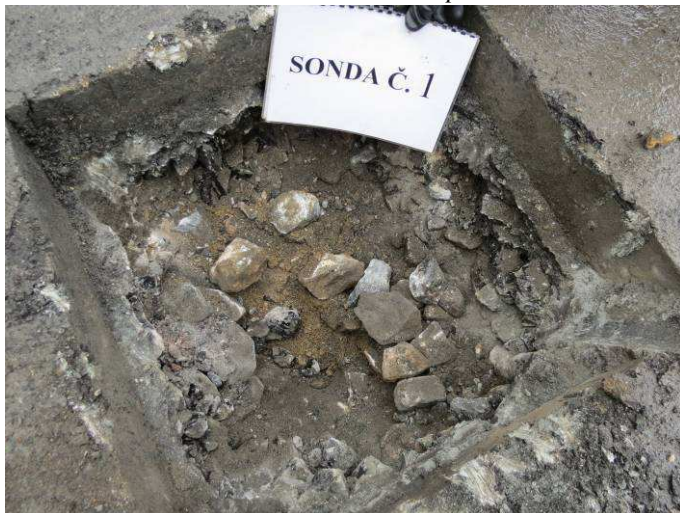
Obr. 4.G Sonda č.1 – štět v úrovni zemní pláň
