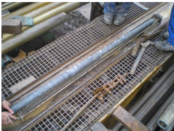
Obr. 5: Jadro vrtané dvojitou jadrovnicou GEOBOR S
