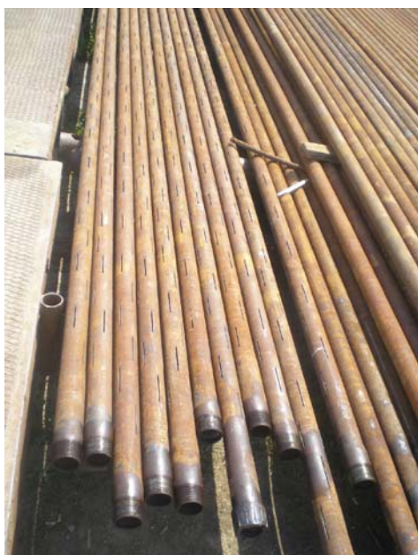
Obr. 12: Filter – perforované pážnice
