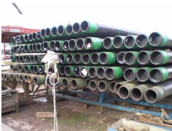
Obr.2 : Použitie pažnice 7“ pri pažení vrtu PVGT – LT1 Obr.
