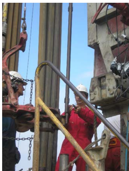
Obr. 7: Zostava spodnej časti vrtnej kolóny
