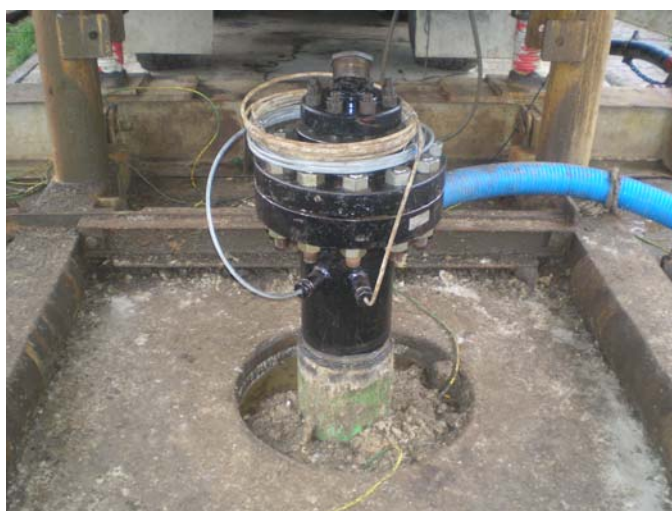
Obr.13 : Zhľavie vrtu PVGT – LT1
