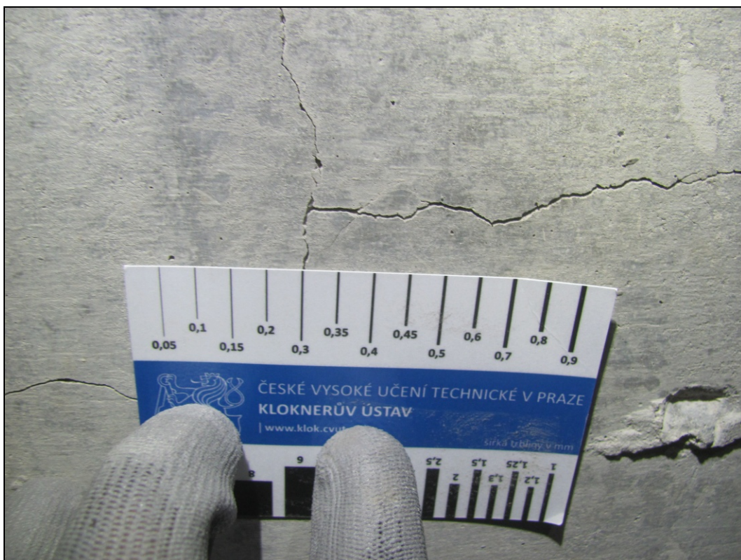
Foto 44: Detail příčnicku u zmonolitněného kloubu v poli 3. Měření šířky trhlin. Trhliny šířky 0,1 – 0,35 mm.
