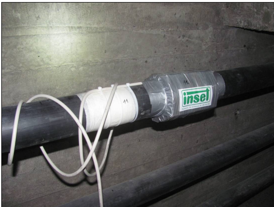
Foto 45: Nově instalovaný snímač pro měření předpětí ve volných kabelech.
