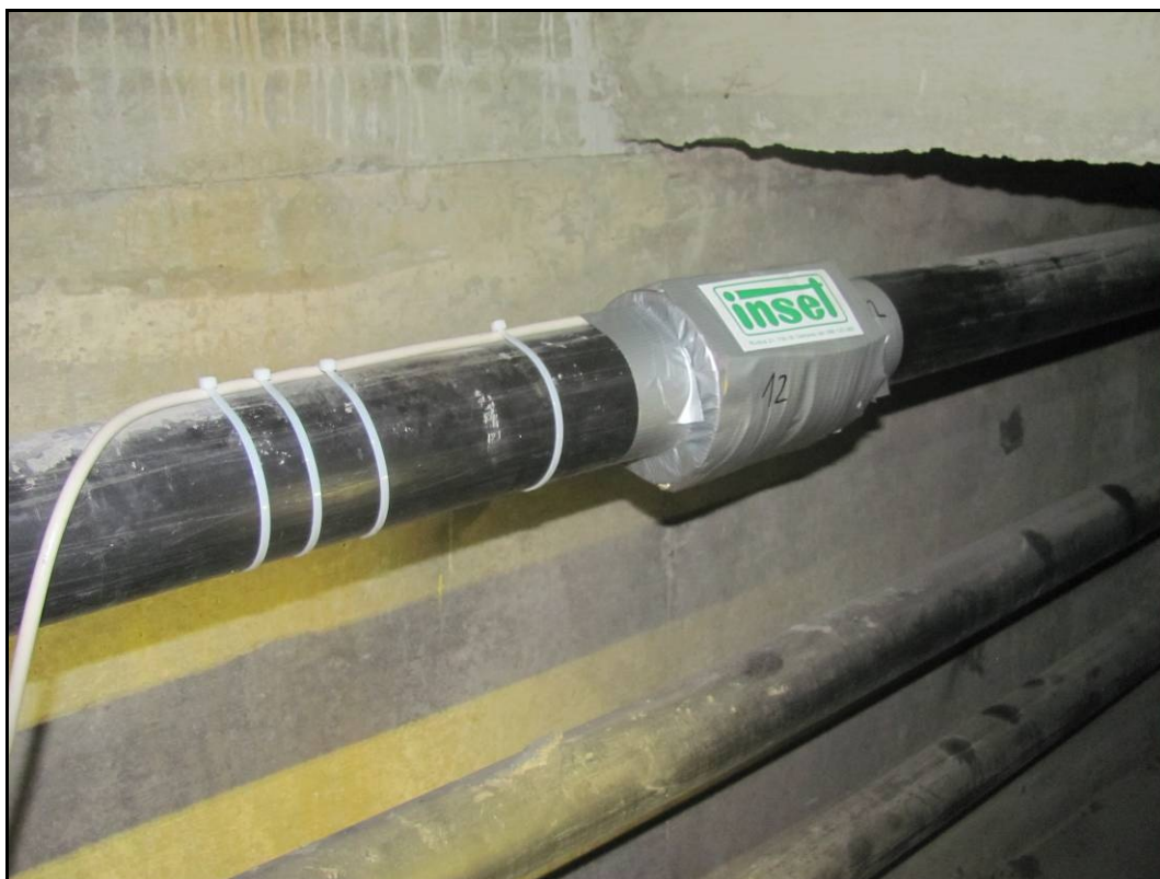
Foto 43: Nově instalovaný snímač pro měření napětí ve volných kabelech.
