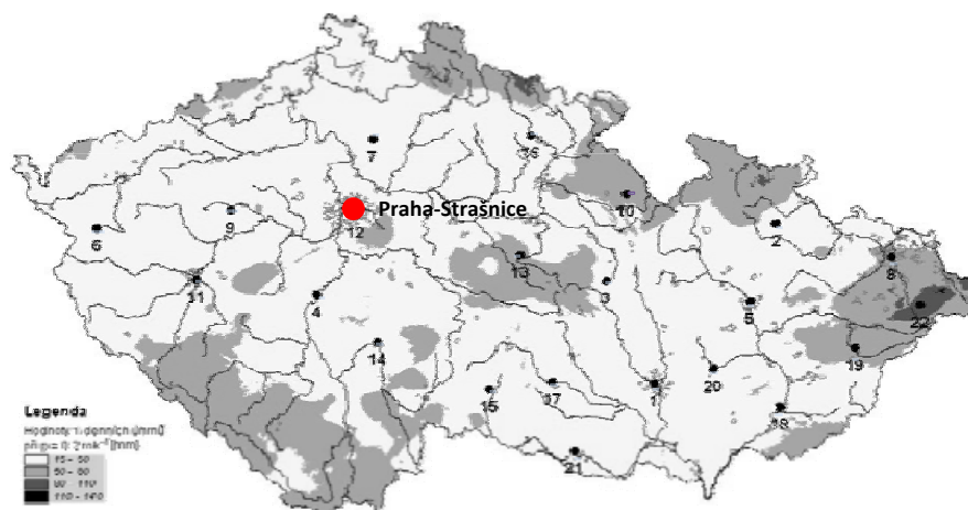
Obrázek A.1 – Přehled doporučených srážkoměrných stanic uvedených v tabulkách A.1 a A.2 situovaných na mapě izolinií jednodenních úhrnů srážek s periodicitou p = 0,2 rok -1
