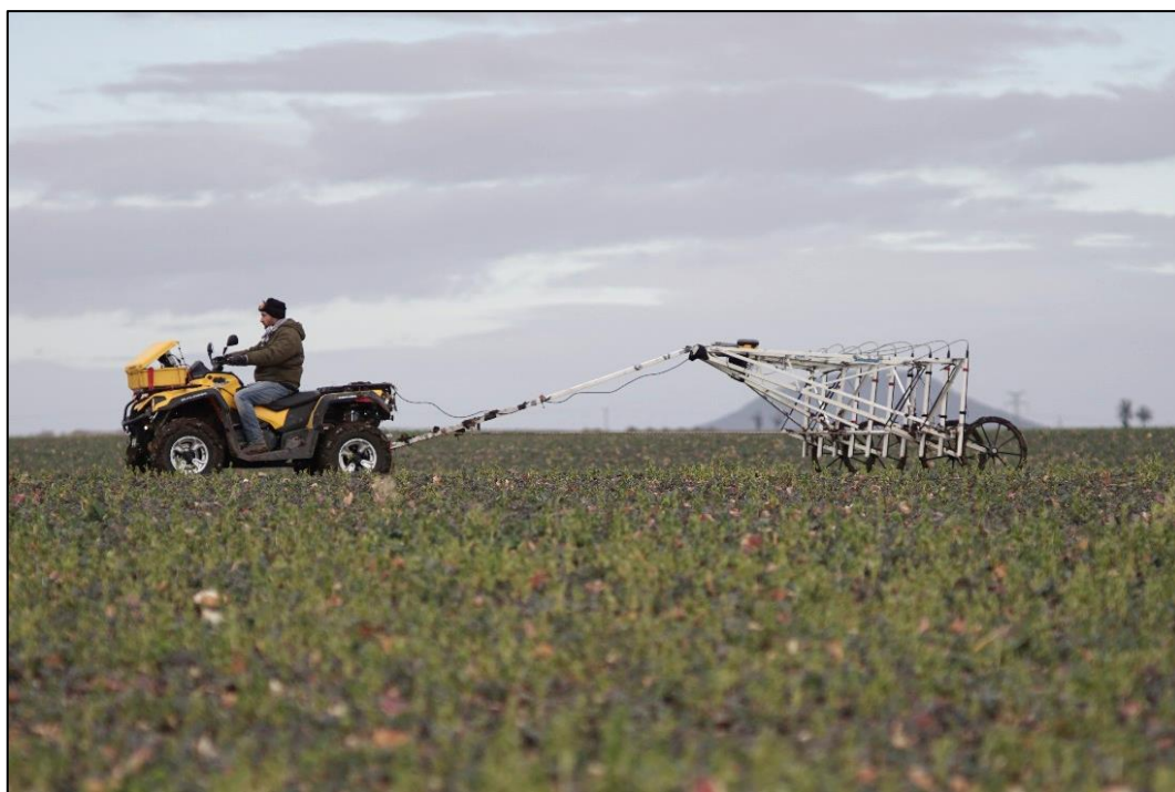
Obrázok 6: Fluxgate magnetometer LEA MAX – „ATV“ mód (Eastern Atlas, Nemecko).
