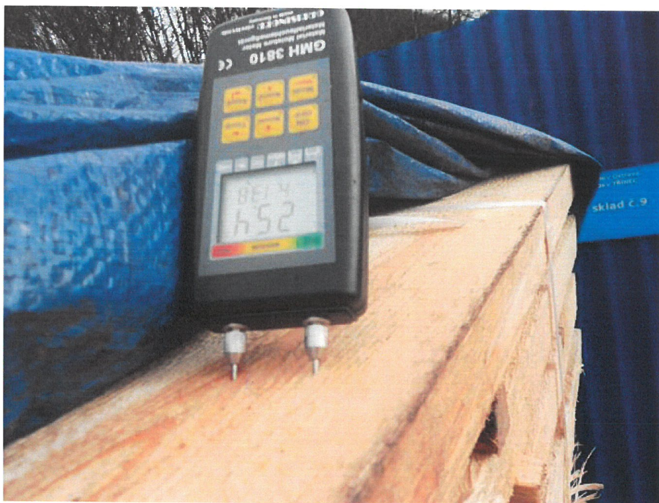
Obrázek č. 1 – „Způsob měření namátkové vlhkosti“
