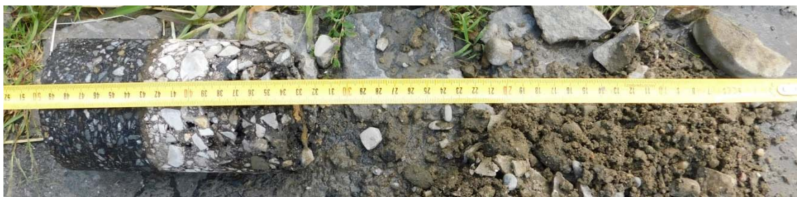
Obr. 4.28: Výnos jádra sondy S2, v krajnici vozovky vpravo.
