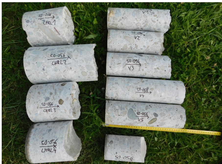
Obr. 4.18: Odebrané jádrové vývrty, vpravo vývrty DN 100 pro zkoušku pevnosti a nasákavosti, vlevo vývrty DN 150 pro zkoušku odolnosti vůči CHRL
