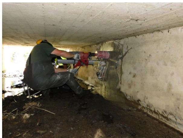
Obr. 4.17: Odběr jádrového vývrtu z opěry.
