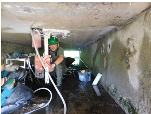
Obr. 4.16: Odběr jádrového vývrtu z monolitické ŽB desky, kvůli prefabrikovaným nosníkům z obou stran mostu nebyl odběr z boku desky možný, bylo nutné odebrat vývrty zdola.
