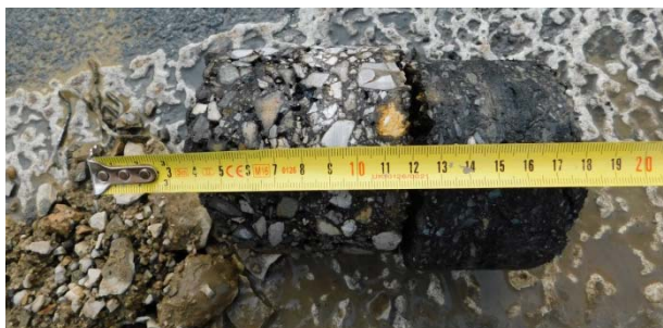
Obr. 4.27: Výnos jádra sondy S1, v krajnici vozovky vlevo.
