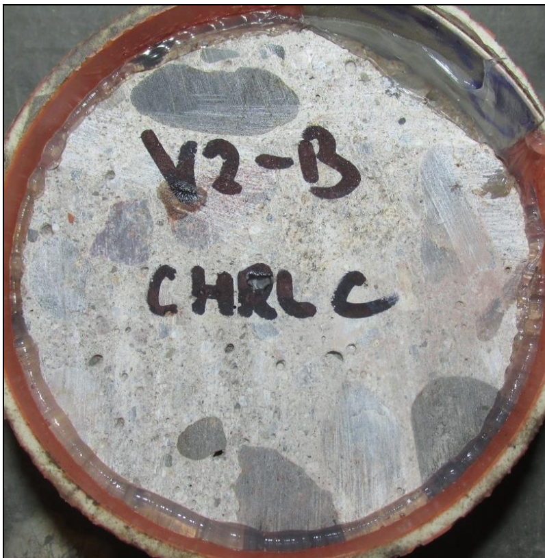
Foto 6: Celkový pohled na čelo vývrtnu V2 před zkouškou (po odstranění lící vrstvy, která byla podrobena tahovým zkouškám – viz Kapitola 3.5)
