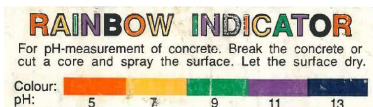
Obr. 3 Barevné spektrum RAINBOW INDICATOR s ohledem na pH betonu
