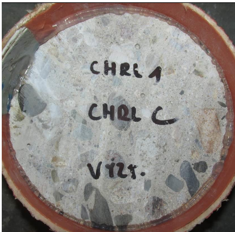
Foto 4: Celkový pohled na čelo vývrtu CHRL1 před zkouškou (po odstranění lící vrstvy, která byla podrobena tahovým zkouškám – viz Kapitola 3.5)
